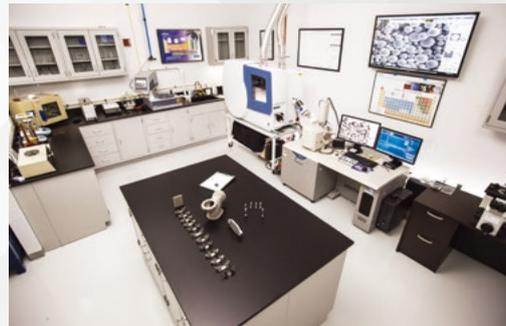
Sintaviaの材料分析ラボは、粉体の品質、サイズ、形状、形態、酸素含有量、水分レベルを制御および最適化するための設備を有しています。
